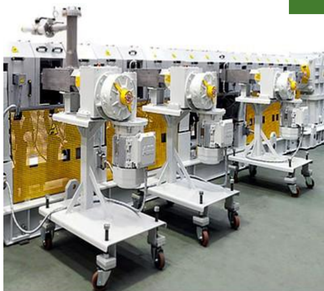
3 dozowniki boczne zainstalowane na kompanderze MARIS
