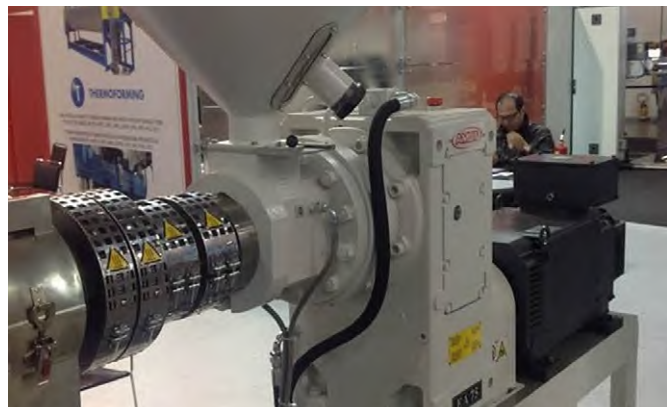
Rys. 3. Uniwersalny korpus umożliwia łatwą instalację napędu w dowolnej pozycji montażowej
