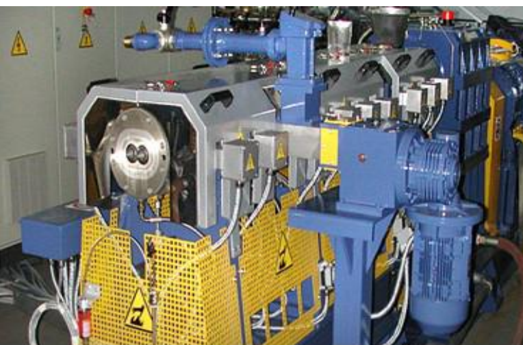
System odgazowania przez dozownik boczny – patent MARIS
