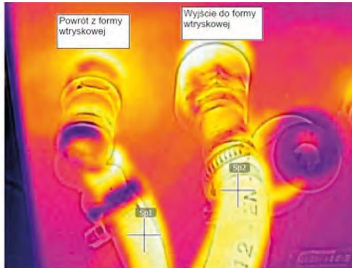
Rys. 5. Termogram przewodów wodnych obrazujący temperaturę przewodu na wyjściu do formy wtryskowej i na powrocie z formy wtryskowej z akceptowalnym odchyleniem (źródło: opr. własne)
