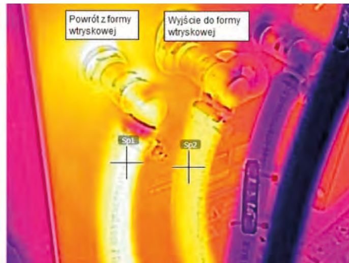
Rys. 6. Termogram przewodów wodnych obrazujący temperaturę przewodu na wyjściu do formy wtryskowej i na powrocie z formy wtryskowej z odchyleniem stanowiącym ryzyko deformacji wypraski (źródło: opr. własne)
