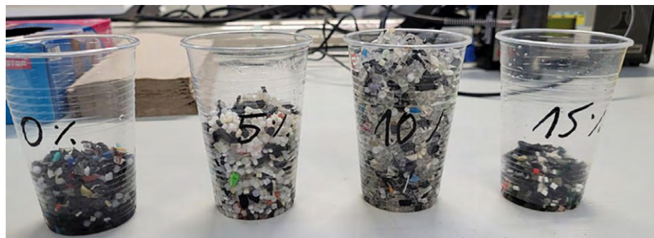
Rys. 7. Próbkę rozdzielone po badaniu flotacji w zależności od stężenia roztworu
