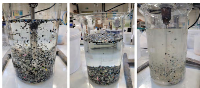
Rys. 6. Badanie flotacji prowadzone na zmieszanych odpadach polimerowych o średnicy ziarna 2,5 – 6,0 mm
