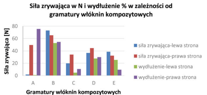
Wykres 7. Mechaniczna wytrzymałość - siła zrywająca [N] i wydłużenie [%] połączeń kompozytów włókninowych na worki i rękawy [7]
