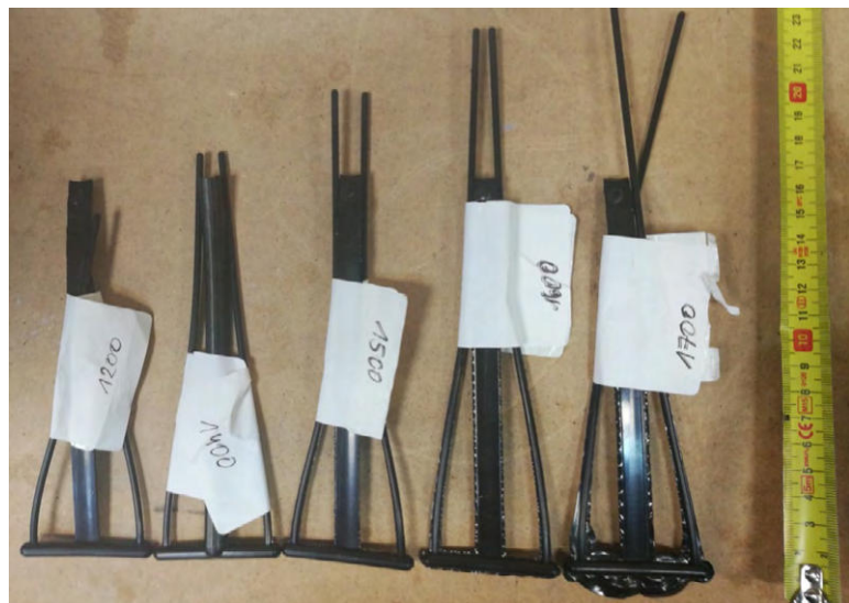
Rys. 1. Fotografia przewłeczek wykonanych techniką wtryskiwania przy ciśnieniu wtrysku od 120 do 170 MPa
