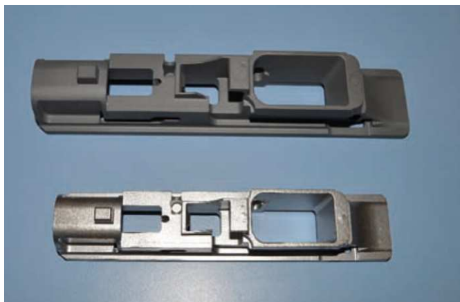
Rys. 10. Element stalowy produkowany przez firmę MIMECRI S.A. po formowaniu wtryskowym oraz spiekaniu
