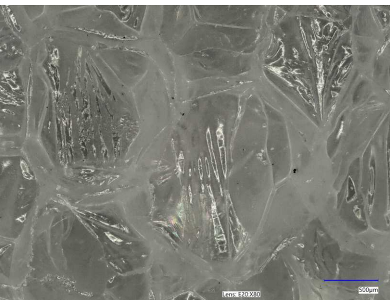
Fot. 3. Widok przekroju polietylenowej pianki po napromieniowaniu dawką 100 kGy
