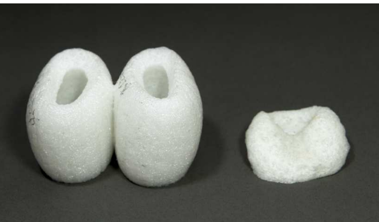
Fot. 2. Polietylenowe pianki ogrzewane 10 min w temperaturze 200°C. Od lewej próbki napromieniowane dawkami 50 i 100 kGy oraz próbka nienapromieniowana
