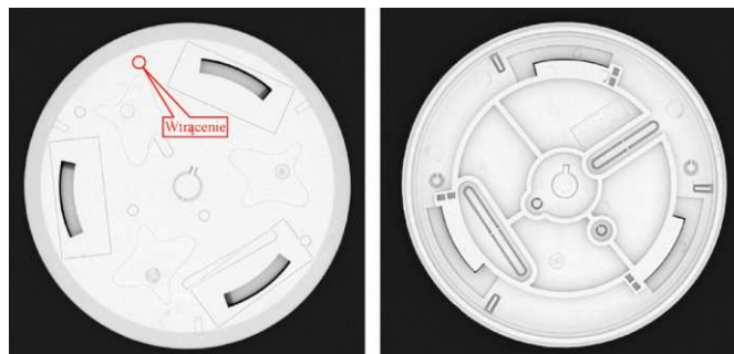
Rys. 1. Przykład detalu polimerowego podlegającego kontroli z zaznaczonym wtrąceniem
