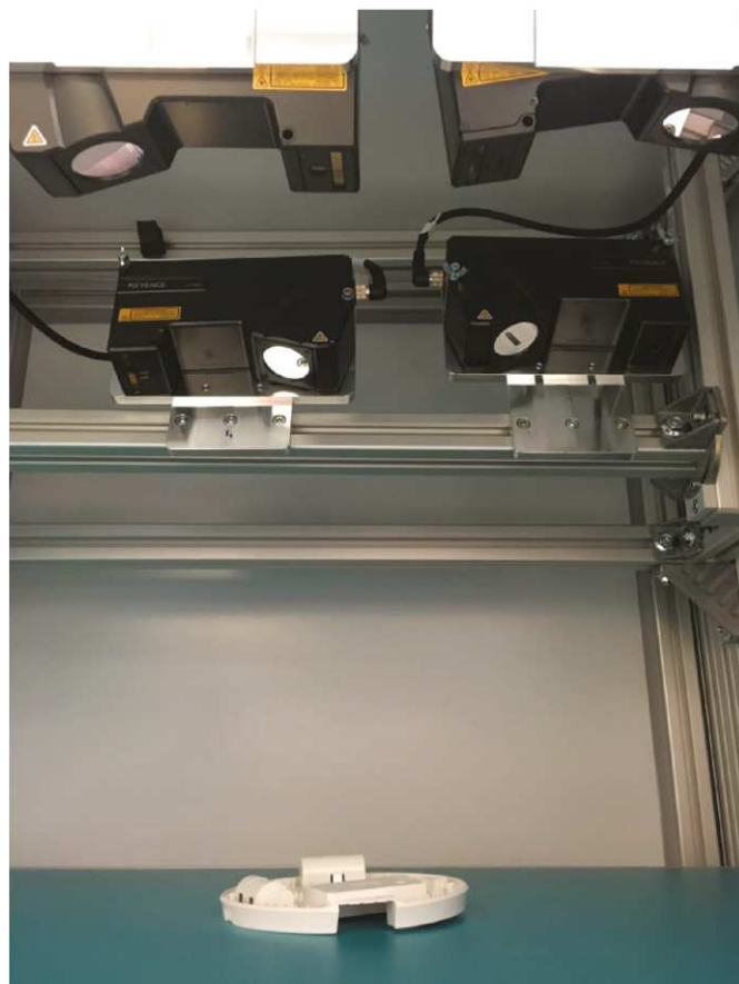
Rys. 5. Wnętrze modułu kontroli geometrii z układem czterech profilometrów laserowych
