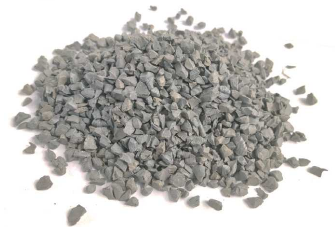
Rys. 3. Kruszywo sztuczne wyprodukowane z mieszanki PET/PVC/OPS
