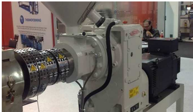
Rys. 3. Uniwersalny korpus umożliwia łatwą instalację napędu w dowolnej pozycji montażowej
