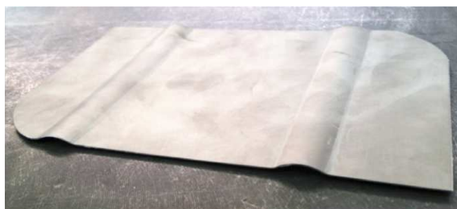
Rys. 9. Przykładowy wyrób z 2 żebrami (na górze) oraz uwidoczniona odchyłka wymiarowa do wyeliminowania (na dole)
