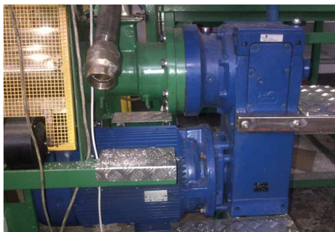
Rys. 2. Motoreduktor w wykonaniu wydłużonym, zastosowany w układzie plastyfikującym
