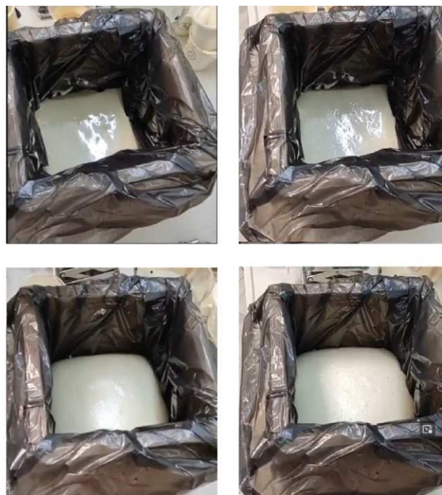
Rys. 6. Spienianie pianek PUR z wykorzystaniem depolimeryzatu PUR
