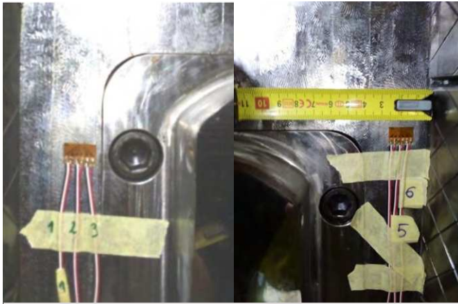
Rys. 2. Rozeta tensometryczna na stanowisku pomiarowym
