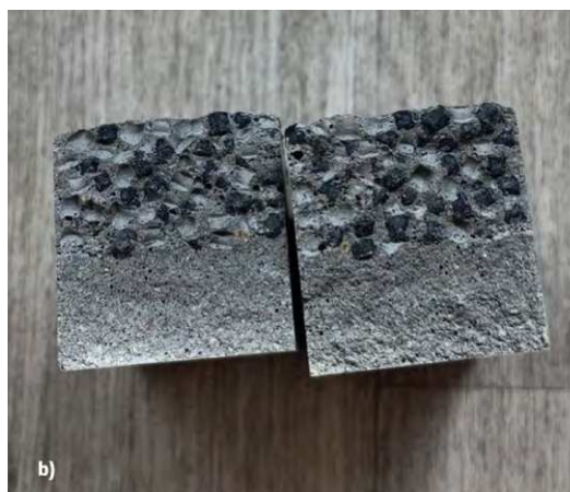
Rys. 3. Wpływ zawartości regranulatu PP na rozplyw mieszanki (a), widoczna segregacja składników w przypadku mieszanki z za dużą ilością SP (b)
