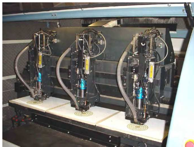
Rys. 10. Wykonywanie separatorów na obrabiarkie wielowrzecionowej [11]
