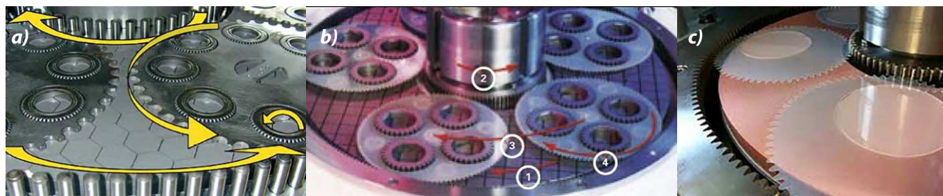
Rys. 3. Obiegowy układ wykonawczy docieraki dwutarczowej do obróbki powierzchni płasko-równoległych: a) kołkowy [7], b) zębata (1 – tarcza docierająca, 2 – zębata pierścień napędzający, 3 – separator, 4 – nieruchomy pierścień zewnętrzny) [7], c) docieranie dużych elementów cienkościennych - napęd zębata [4]
