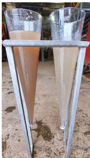
Rys. 3. Porównanie próbek ścieków; ściek surowy (po lewej) i ściek po separatorze faz (po prawej)
