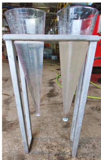
Rys. 4. Porównanie próbek ścieków; ściek po filtracji membranowej (po lewej) i ściek po separatorze faz (po prawej)
