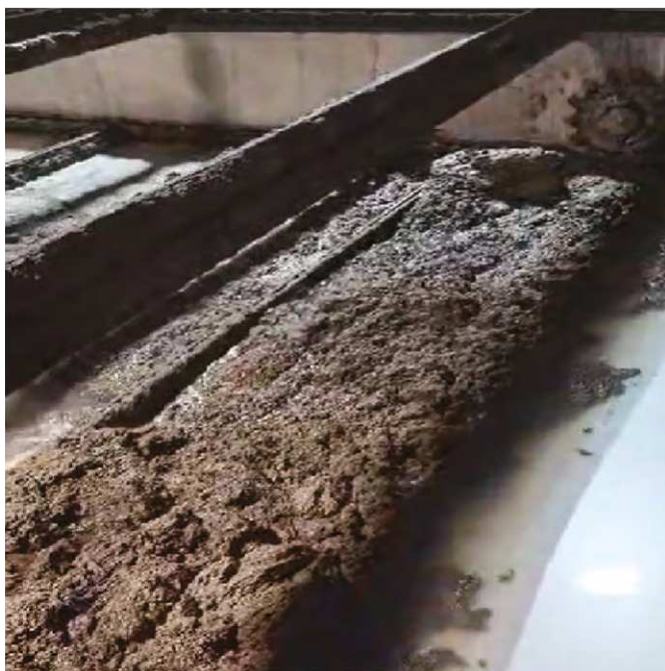
Rys. 5. Osad flotujący w separatorze faz
