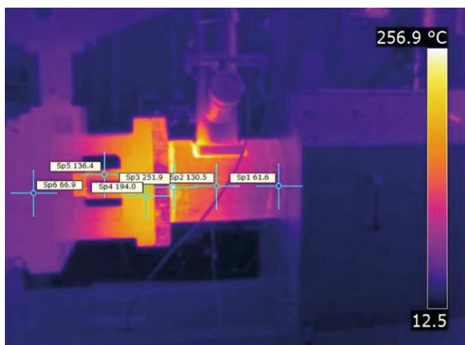
Rys. 4. Wyniki badań termowizyjnych silnie przegrzanego sprzęgła wylączarki - dokumentacja serwisu [6]
