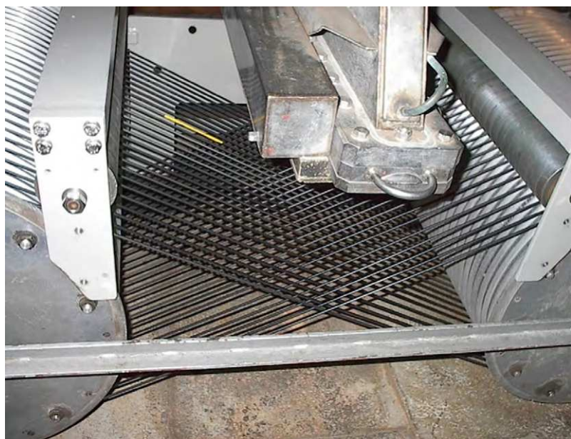
Fot. 1. Akceleratorowa instalacja do radiacyjnego sieciowania izolacji przewodów elektrycznych w IChTJ
