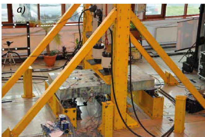
Fot. 1. Panel na stanowisku badawczym (a) oraz reflektometr optyczny LUNA OBR 4600 (b)
