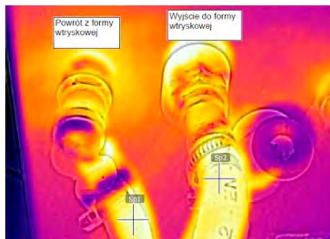
Rys. 3. Termogram przewodów wodnych obrazujący temperaturę przewodu na wyjściu do formy wtryskowej i na powrocie z formy wtryskowej z akceptowalnym odchyleniem
