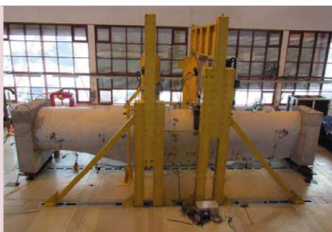
Fot. 2. Dźwigar kładki dla pieszych z kompozytowej łopaty turbiny wiatrowej na stanowisku badawczym
