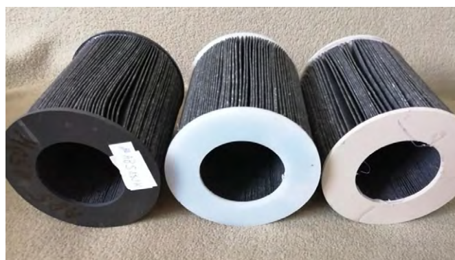
Rys. 4. Filtry wykonane przy zastosowaniu kleju termoplastycznego Pattex Hot Sticks [13]
