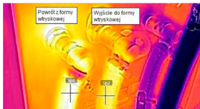
Rys. 4. Termogram przewodów wodnych obrazujący temperaturę przewodu na wyjściu do formy wtryskowej i na powrocie z formy wtryskowej z odchyleniem stanowiącym ryzyko deformacji wypraski
