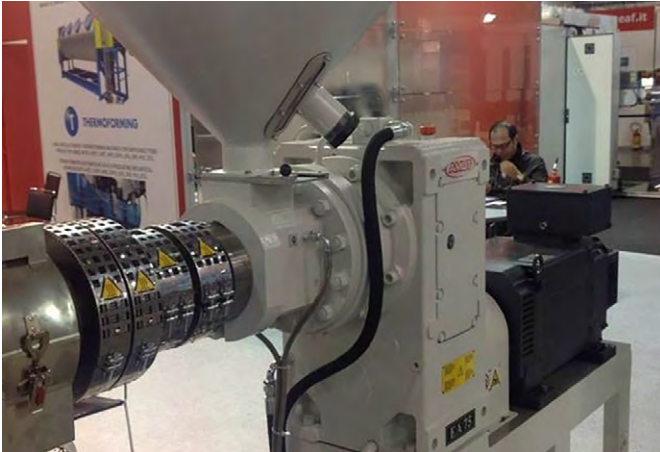
Rys. 3. Uniwersalny korpus umożliwia łatwą instalację napędu w dowolnej pozycji montażowej
