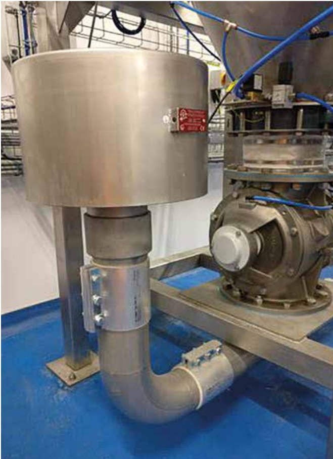
Rys. 7. Ten filtr-tłumik wlotu powietrza z certyfikacją ATEX chroni przed zanieczyszczeniami przy podawaniu materiału do linii transportowej
