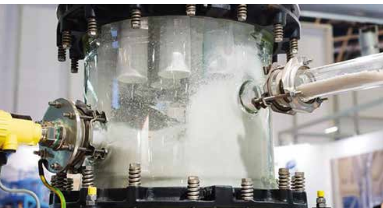
Rys. 1. Przejrzysty zbiornik i orurowanie pozwalają na wizualne potwierdzenie, że system transportu pneumatycznego działa prawidłowo
