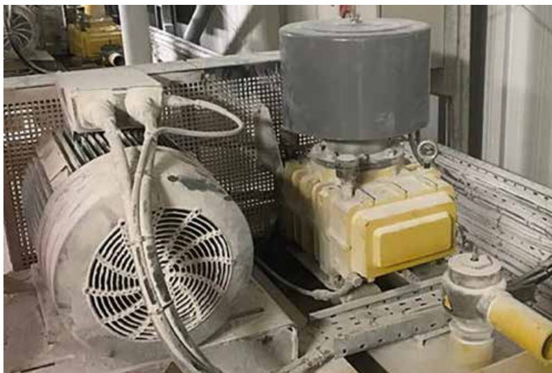
Rys. 5. Dmucha PD z filtro-tłumikiem powietrza wlotowego chroniącym aplikację do transportu cementu
