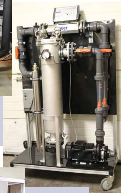
System z wymiennymi wkładami filtracyjnymi montowany w bajpasie na zbiorniku buforowym wody
