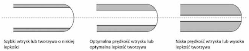
Rys. 5. Wpływ prędkości wtrysku i lepkości stopu na grubość warstwy zakrzepniętej. (Źródło: opr. własne)
