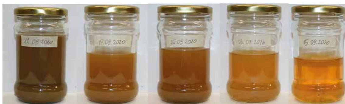
Przed czyszczeniem chemicznym Układu chłodzenia 3 dni po uruchomieniu oczyszczonego układu 12 dni po uruchomieniu 20 dzień po uruchomieniu 32 dzień po uruchomieniu
