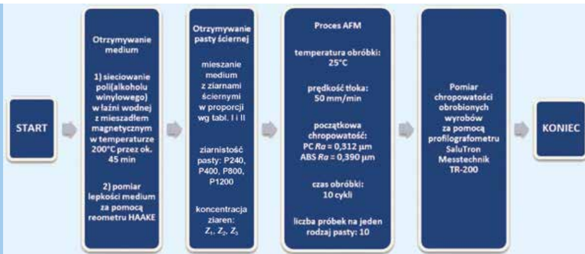
Rys. 4. Procedura przygotowania pasty ścierniej oraz realizacji procesu obróbki przetłoczno-ścierniej wyrobów polimerowych
