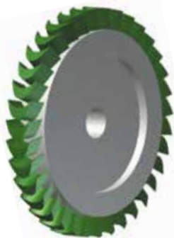
Rys. 1. Trójwymiarowa geometria tarczy wirnikowej mikro turbiny
