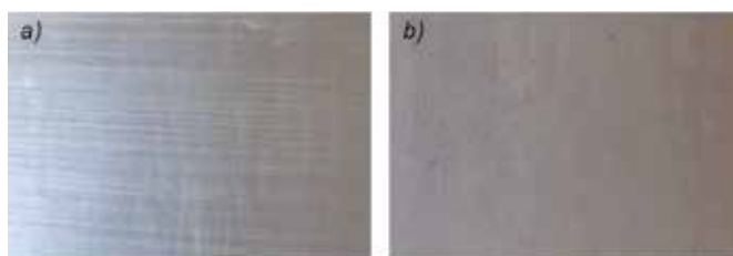
Rys. 10. Powierzchnia polimeru PC: a) przed obróbką wykończeniową, b) po obróbce z użyciem ścierniej pasty polimerowej (po 10 cyklach)
