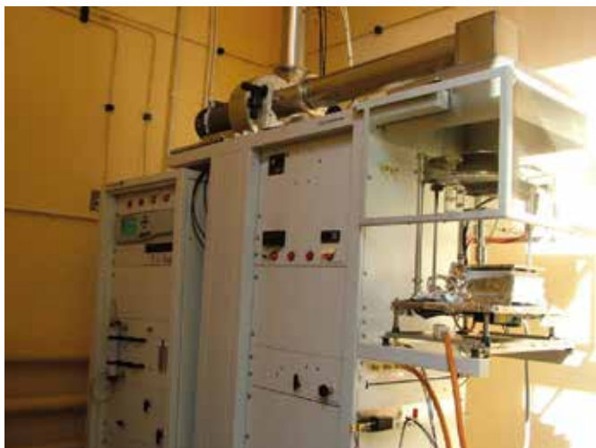
Rys. 2. Kalorymetr stożkowy firmy FTT - widok aparatu
