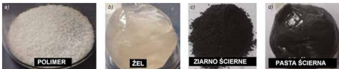
Rys. 3. Składniki (a-c) oraz gotowa pasta ścierna (d)
