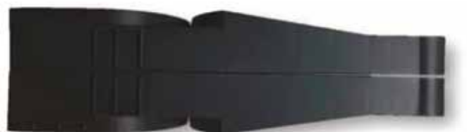
Rys. 1. Zdjęcia wypraski przed optymalizacją kształtu - widoczna deformacja przystających do siebie dwóch wyprasek
