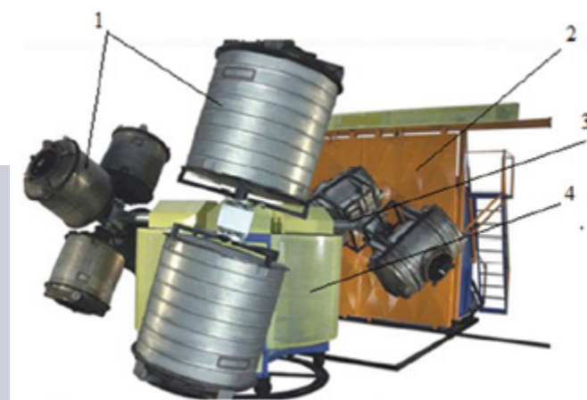
Rys. 3. Maszyna do odlewania rotacyjnego typu karuzelowego trójramienna: 1- formy odlewnicze, 2 - układ grzewczy, 3 - ramię mimośrodowe, 4 - układ chłodzenia [1]
