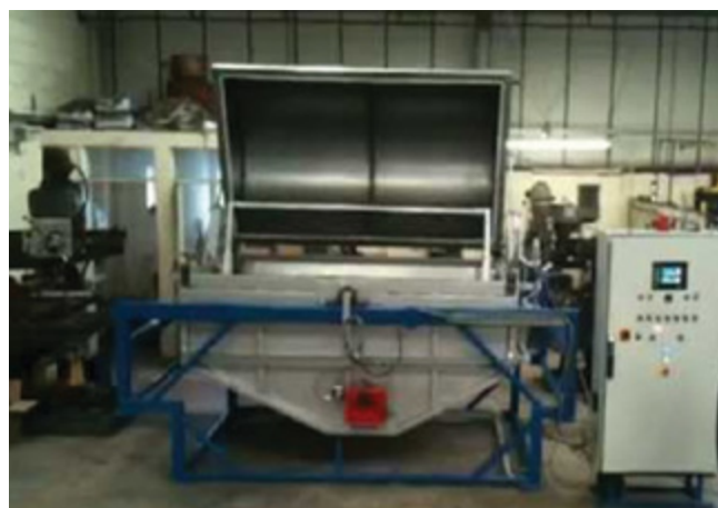
Rys. 5. Maszyna do odlewania rotacyjnego typu skorupowego [4]
