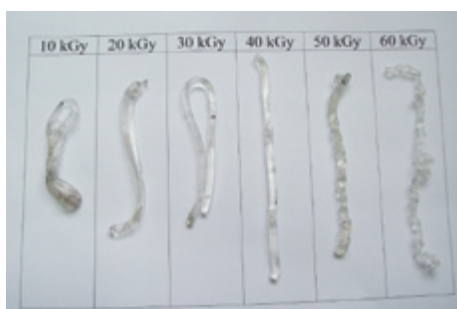
Rys. 5. Wpływ dawki promieniowania gamma na wartość wskaźnika szybkości płynięcia. Powyżej 20 kGy pojawiają się niestopione granulki polimeru
