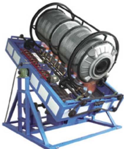
Rys. 6. Maszyna do odlewania rotacyjnego typu kołyskowego [2]
