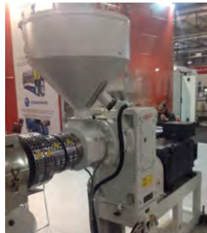
Rys. 2. Uniwersalny korpus umożliwia łatwą instalację napędu w dowolnej pozycji montażowej
