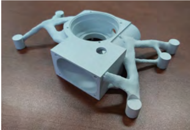
Rys. 2. Korpus aluminiowy po optymalizacji ukierunkowanej na produkcję przy wykorzystaniu techniki addytywnej
