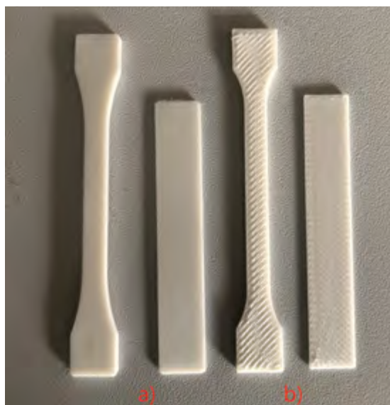
Rys. 3. Kształtki otrzymane odpowiednio: a) metodą formowania wtryskowego; b) w technologii druku 3D
