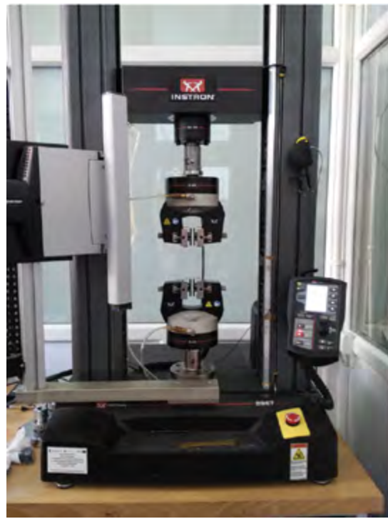
Rys. 5. Maszyna wytrzymałościowa INSTRON 5967
