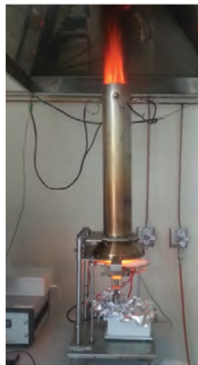
Rys. 6. Mikrokalorymetr stożkowy do charakterystyki procesu spalania materiałów polimerowych zgodnie z normą ISO 13927, aparat do wyznaczania indeksu tlenowego EN ISO 4589
