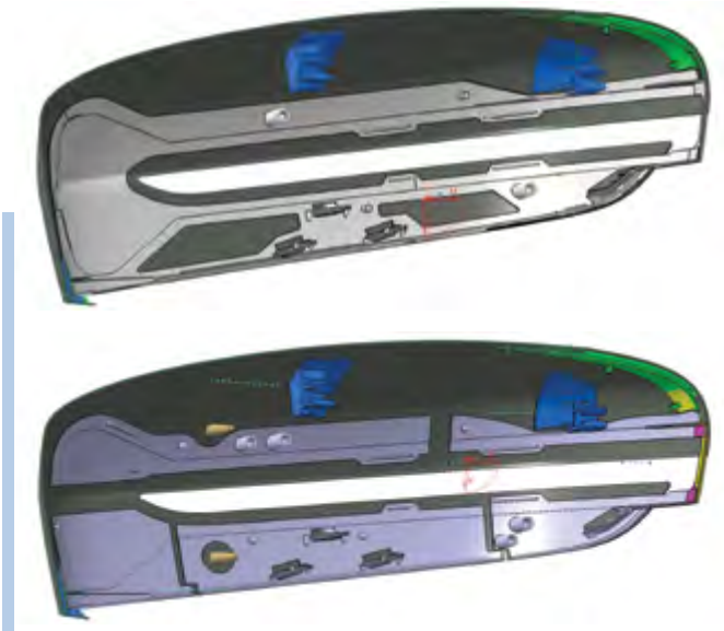
Rys. 12. Widok insertu lusterka przed zmianami (u góry) i po optymalizacji (na dole)
