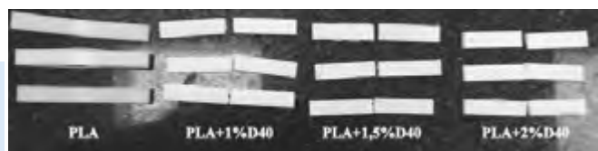
Rys. 3. Widok próbek po zrealizowaniu trójpunktowego zginania (opracowanie własne)
