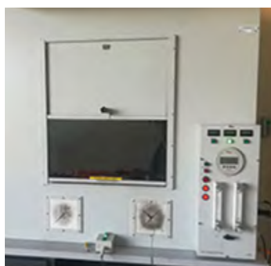
Rys. 7. Komora UL-94 do badania palności metodą płomieniową PN-EN 60695-11-10
