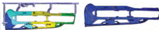
Rys. 9. Wtrysk bez zastosowania środkowej przewężki. Po lewej - udział przewęzek w wypełnieniu. Po prawej - miejsca występowania niekorzystnych zetknięć frontów płynącego tworzywa
