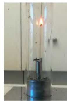
Rys. 6. Mikrokalorymetr stożkowy do charakterystyki procesu spalania materiałów polimerowych zgodnie z normą ISO 13927, aparat do wyznaczania indeksu tlenowego EN ISO 4589
