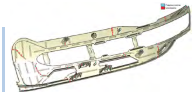
Rys. 7. Pułapki powietrzne i linie łączenia
