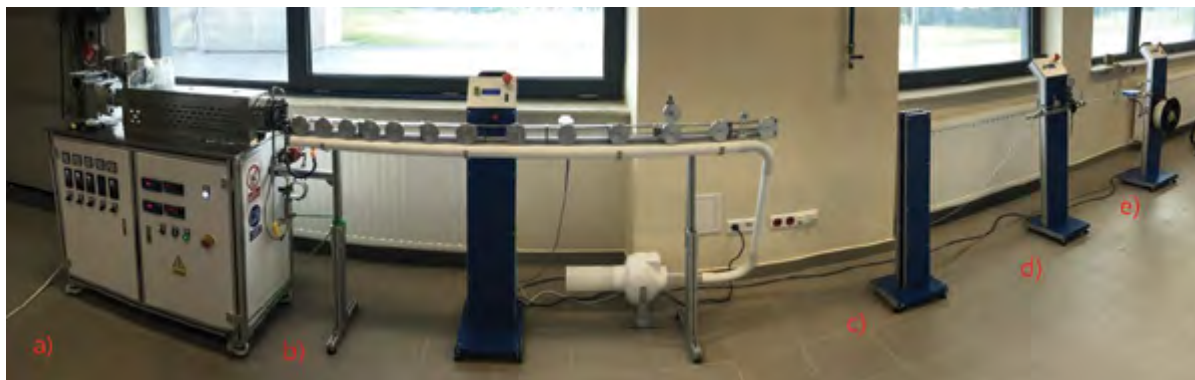
Rys. 2. Linia technologiczna do otrzymywania filamentów: a) widok wytłaczarki jednoślakowej wraz z lejem zasypowym, b) widok odciągu rolkowego chłodzonego strumieniem powietrza wraz z pulpitem sterującym, c) system czujników szybkości odciągania filamentu, d) sekcja do pomiaru średnicy filamentu, e) nawijarka z pulpitem sterującym
