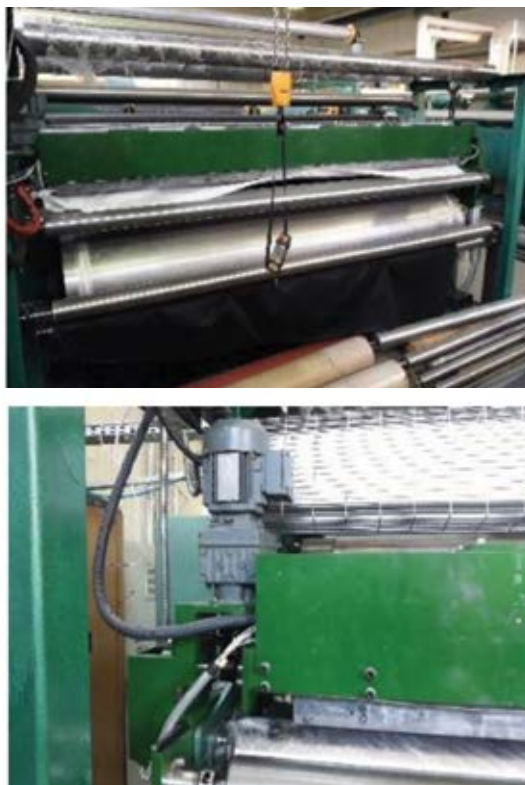
Rys. 10. Układ zabudowy głowicy dozującej z zamontowanym płytowym zespołem kompensacji prostoliniowości głowicy w maszynie laminującej
