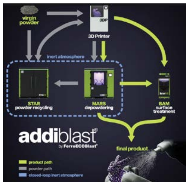
Rys. 1. Rozwiązanie dotyczące integracji urządzeń do realizacji post-processingu wydrukowanych elementów
