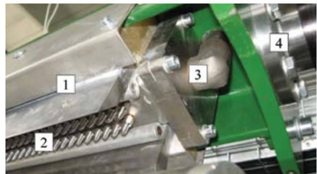
Rys. 5. Głowica zainstalowana w ciągu technologicznym: 1 - nóż zgrarniający, 2 - dysze, 3 - kolano rurociągu oleju grzewczego, 4 - wahliwe zawieszenie głowicy
