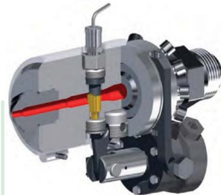
Rys. 1. Dysza zamykana wtryskarki. (Źródło: herzogsystemsag.com)
