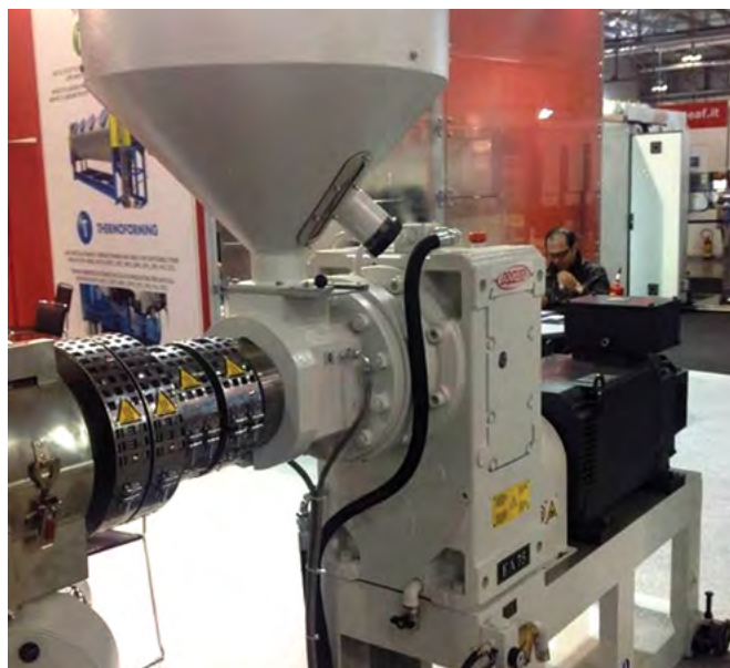
Rys. 2. Uniwersalny korpus umożliwia łatwą instalację napędu w dowolnej pozycji montażowej
