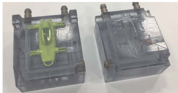
Rys. 5. Widok wydrukowanej formy i formy z wypraską
