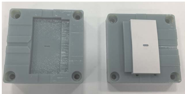
Rys. 4. Widok wydrukowanej formy i formy z wypraską
