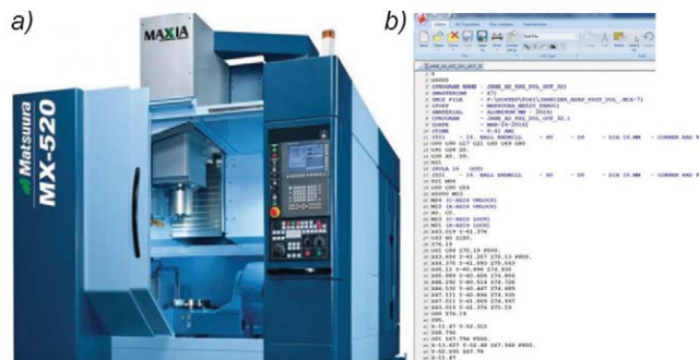
Rys. 6. Obrabiarka użyta do obróbki płyty kształtowej (a), fragment kodu sterującego NC (b)
